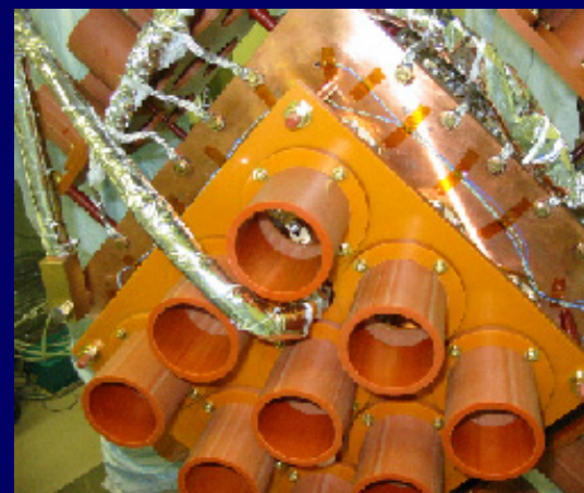
実験中の100kgのチェンバー(liq.Xeの容器は銅)
