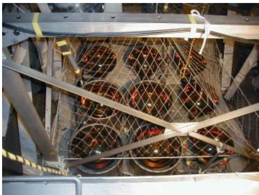
図5 ステンレス筒のセットアップ。手前左の4本にステンレス筒が取り付けられている。
