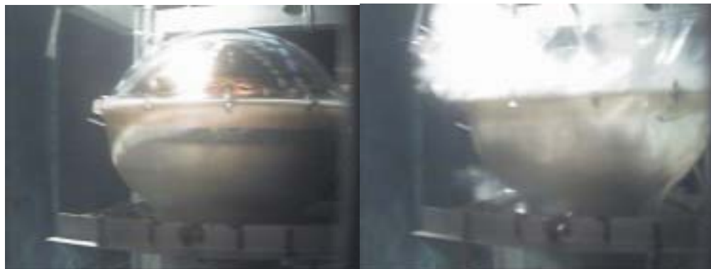
図11 FRP - 破壊の様子
