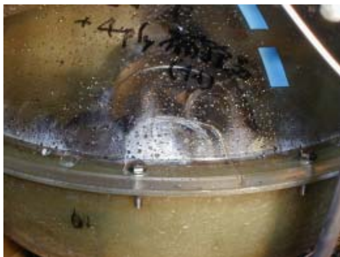
図12 FRP - のアクリル部の亀裂
